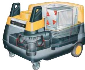
**Электростатический фильтр** состоит из трех секций: механического предварительного фильтра, ионизационной ячейки, в которой частицы заряжаются, и осадительной ячейки с полезной площадью 14,2 м<sup>2</sup>.
