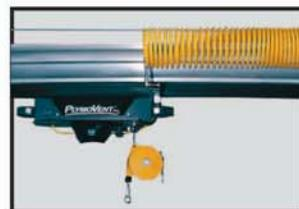
Для работы с такими насадками необходим источник сжатого воздуха, а вдоль рельса–воздуховода натягивается поддерживающая струна на которой расположен спиральный шланг подачи сжатого воздуха. Такой шланг растягивается вслед за перемещением каретки. Каретки этой серии применяются со специальным набором НРА серии, включающим вытяжной шланг ЕН длиной 6м, пневмозахват GRABBER и пр. принадлежности.
