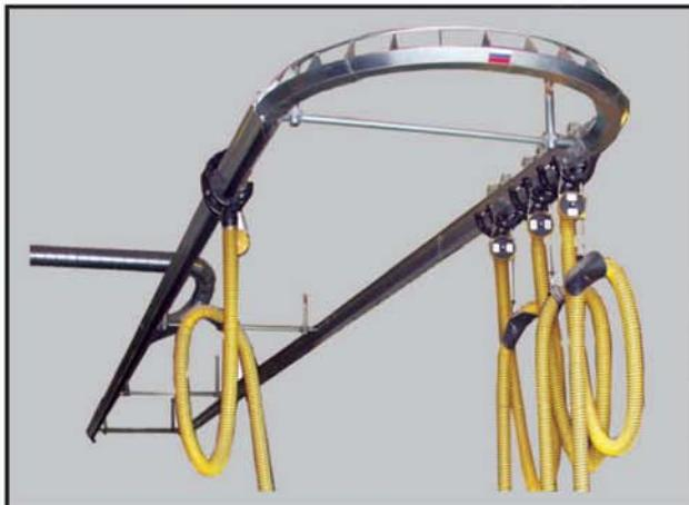
Кольцевая рельсовая вытяжная система любой сложности состоит из двух основных "участков" – секций вытяжного рельса–воздуховода и секций возвратного рельса, соединенных дуговым участком возвратного рельса. По вытяжному рельсу–воздуховоду перемещаются подвижные каретки (вытяжные устройства), подключенные через вытяжной шланг к выхлопным трубам, а по возвратному рельсу освободившиеся каретки возвращаются ко въезду в гараж.
